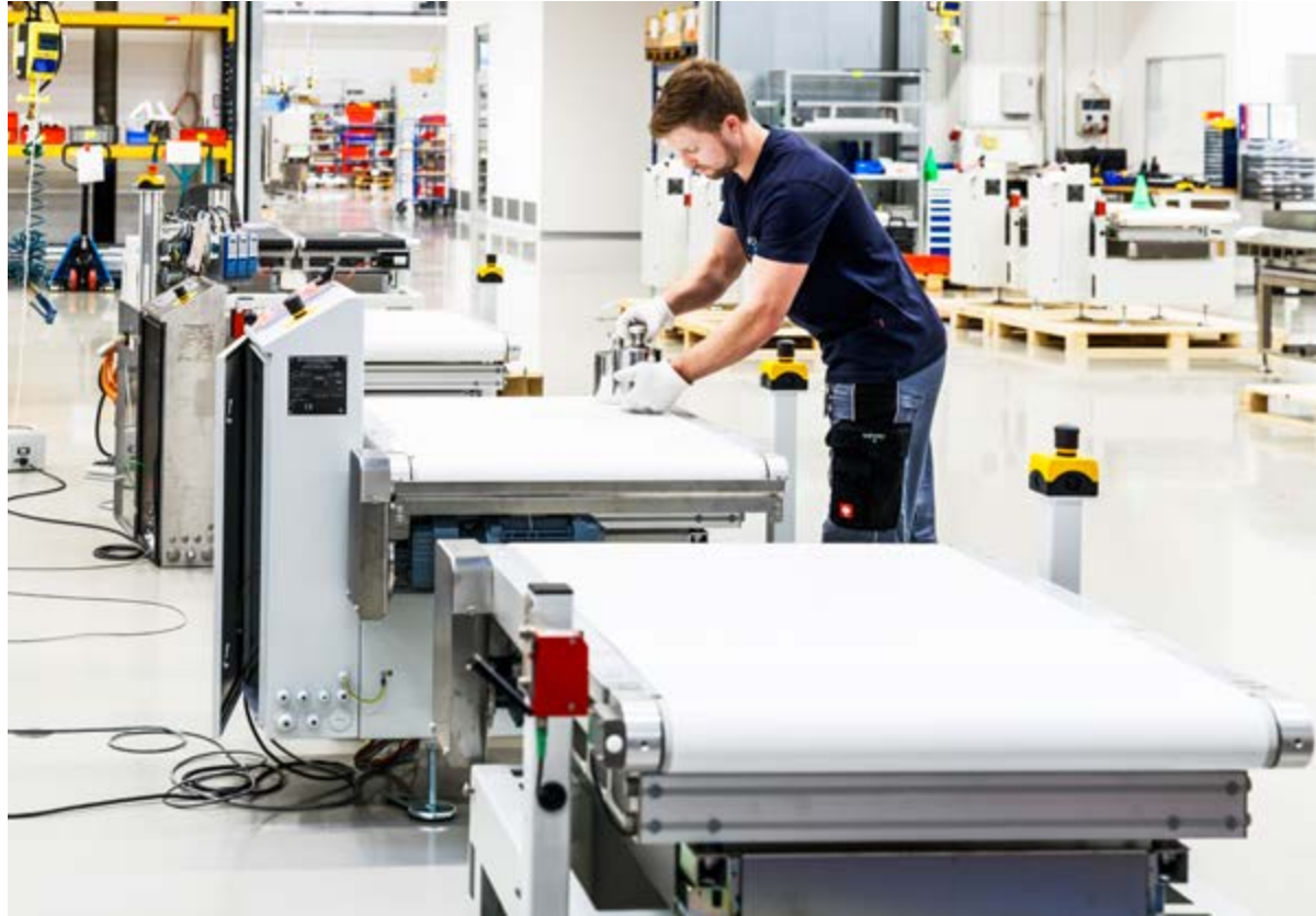
Endabnahme und Test einer Schwerlast- kontrollwaage
